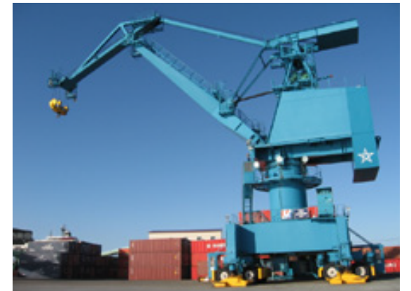
西港第4埠頭でコンテナの積み下ろしに使っているジブクレーン。大型ガントリークレーンに切り替えれば、貨物は増えると市は言います。
