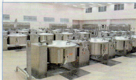
煮炊調理室 スープ・カレーなどを調理します。 1釜で約1500人分調理できます。
